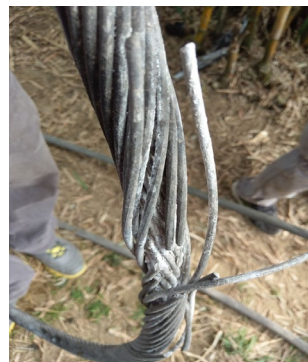
導、地線、鐵塔構材鏽蝕嚴重
